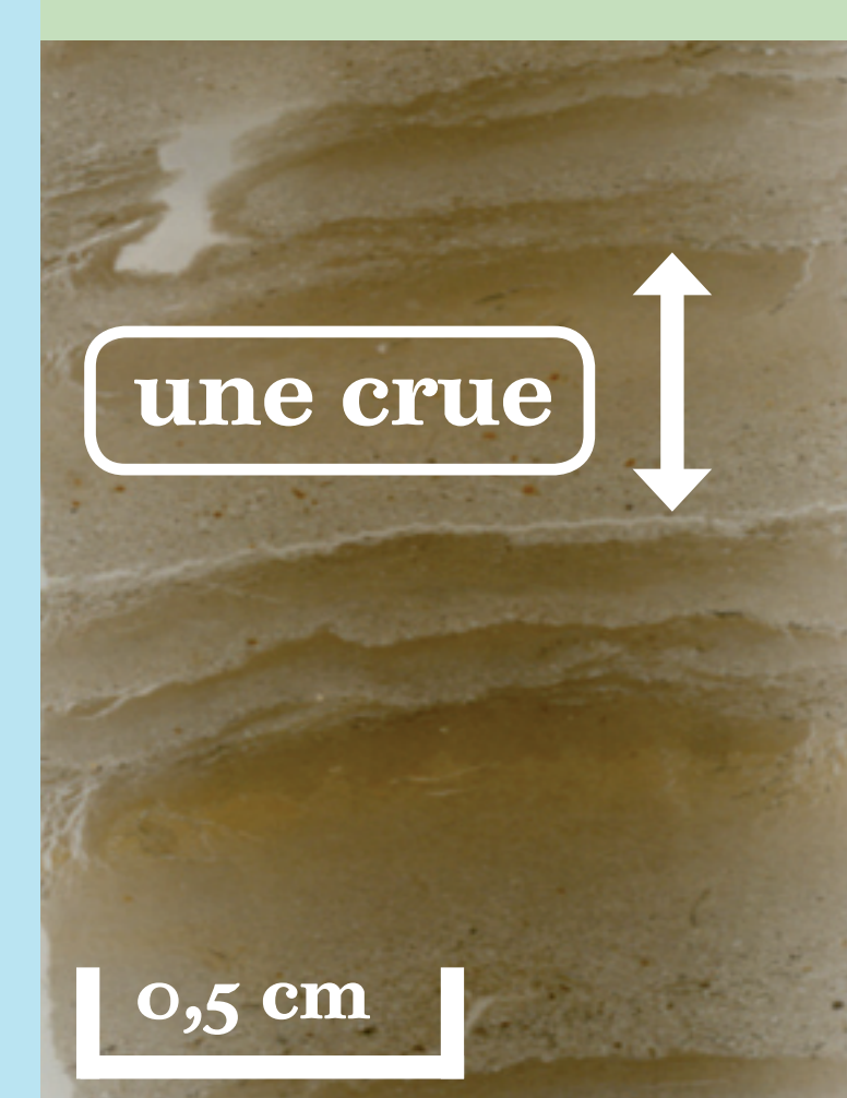
Un tronçon de carotte Le sédiment est imprégné de résine puis découpé en lames minces pour être observé au microscope. Chaque lamelle correspond à une crue des torrents.
